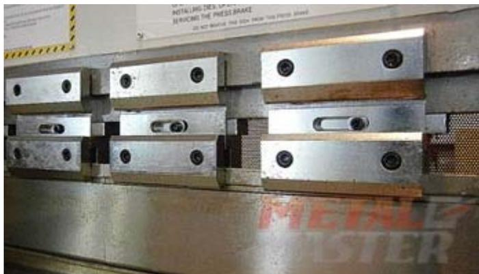
На станке установили одну из наиболее распространенных систем крепления – AMADA-PROMECAM. Это позволяет, в случае необходимости, легко поменять или подобрать более подходящий для гибки сложного изделия инструмент.
