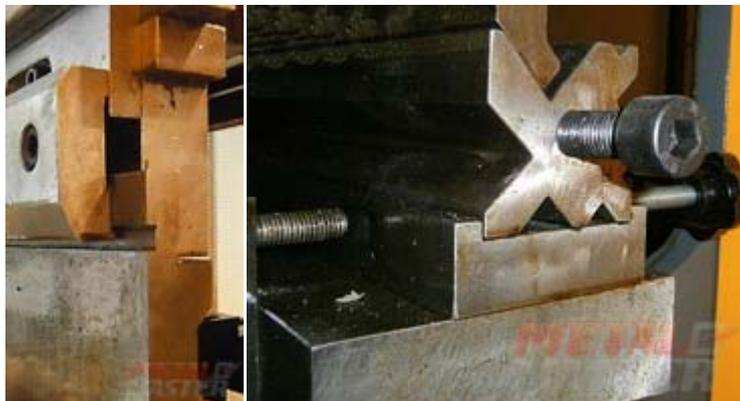
Стол, на котором размещается матрица плоский. Это позволяет устанавливать на гибочный пресс поворотные матрицы любого типа. В базовой комплектации поставляется многоручьевая четырехсторонняя матрица.
