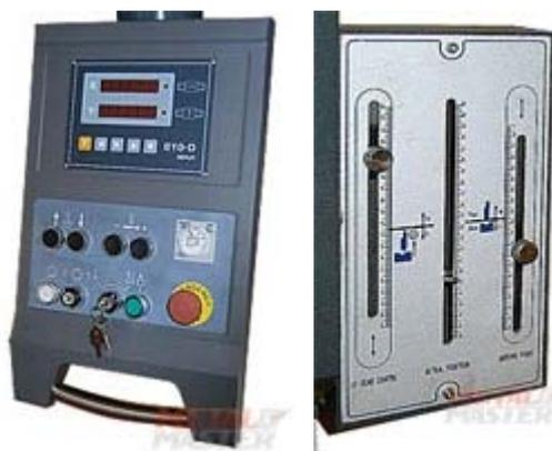
При помощи простых передвижных указателей, расположенных на дополнительной панели, можно быстро задать высоту подъема ножа и установить границу переключения скорости подачи и рабочего хода паузона.
